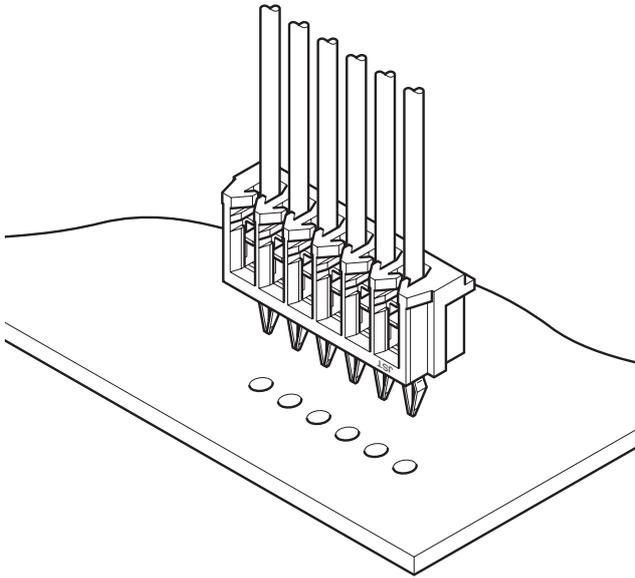
该产品是间距为 2.0mm、电路板封装高度为 5.0mm、厚度仅为 4.0mm 的印刷电路板直接安装型压接连接器。需要对 VTR、摄像机、立体声系统、车载收音机等小型电子设备进行合理化配线时，请单独使用或与接插型 DR 连接器配对使用。
