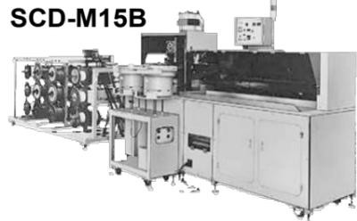
自动压接机：2mm/2.5mm间距跳线排线
