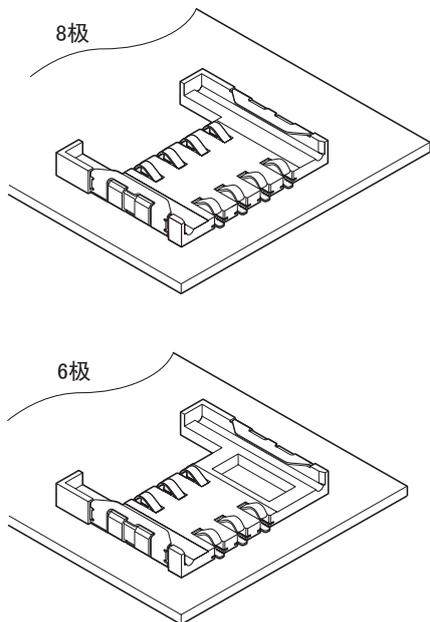
该产品是面向欧洲数字移动电话 GSM、适用 GSM11.11 标准的 SIM 卡及第 3 代移动电话方式 (W-CDMA) 的 USIM (UIM) 卡用连接器。
